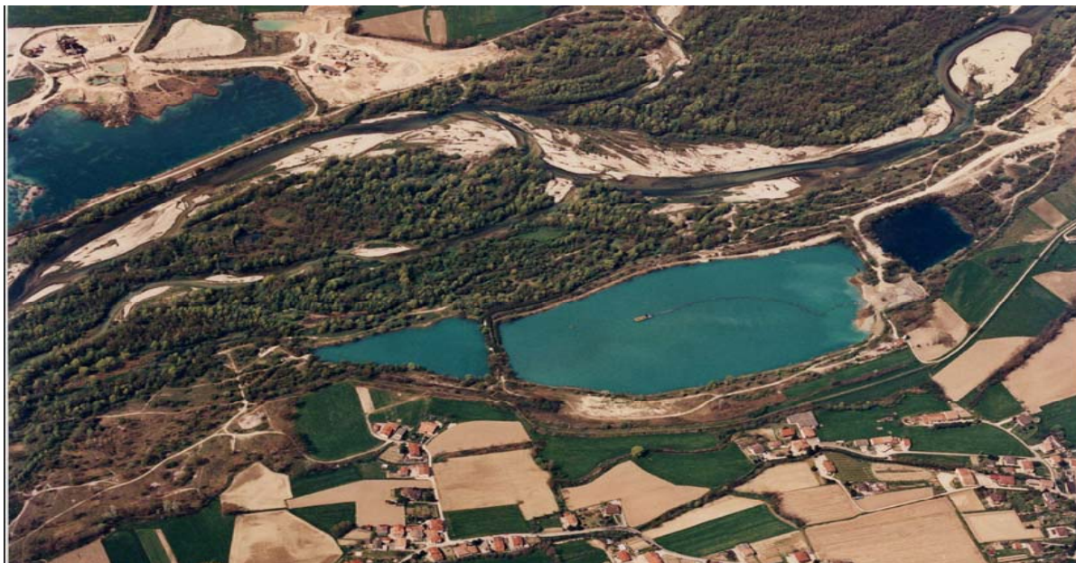
Figura 2.5: affioramento della falda nei bacini Crivellaro e Finesso presso l'abitato di Fontaniva (foto del 1996).
