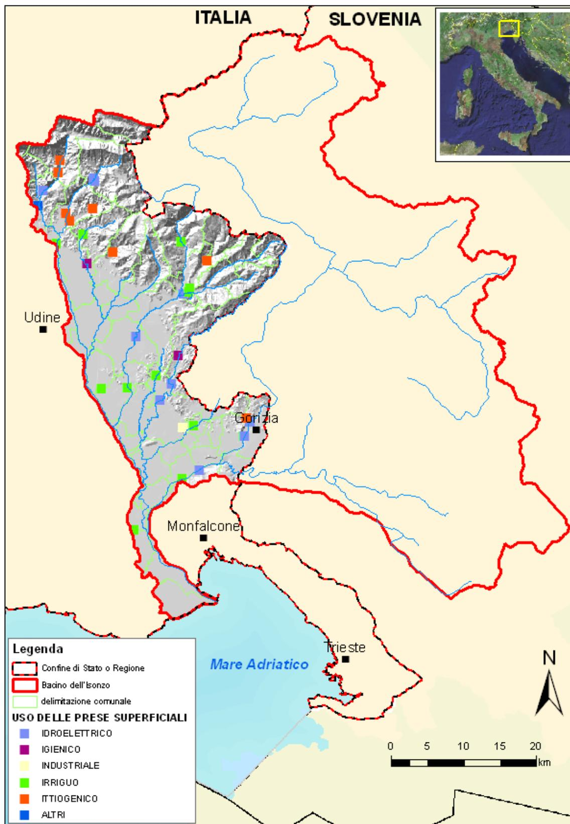
Figura 2.15: indicazione planimetrica delle principali derivazioni superficiali analizzate nel bacino idrografico del fiume Isonzo (parte italiana).
