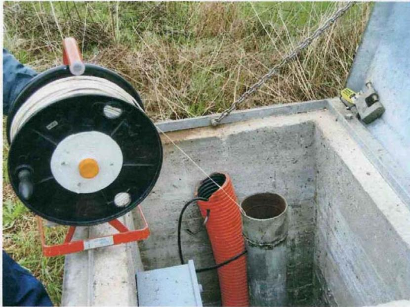
LAYOUT DI POZZO CON INSERITO SENSORE PIEZORESISTIVO E CAVO DI
