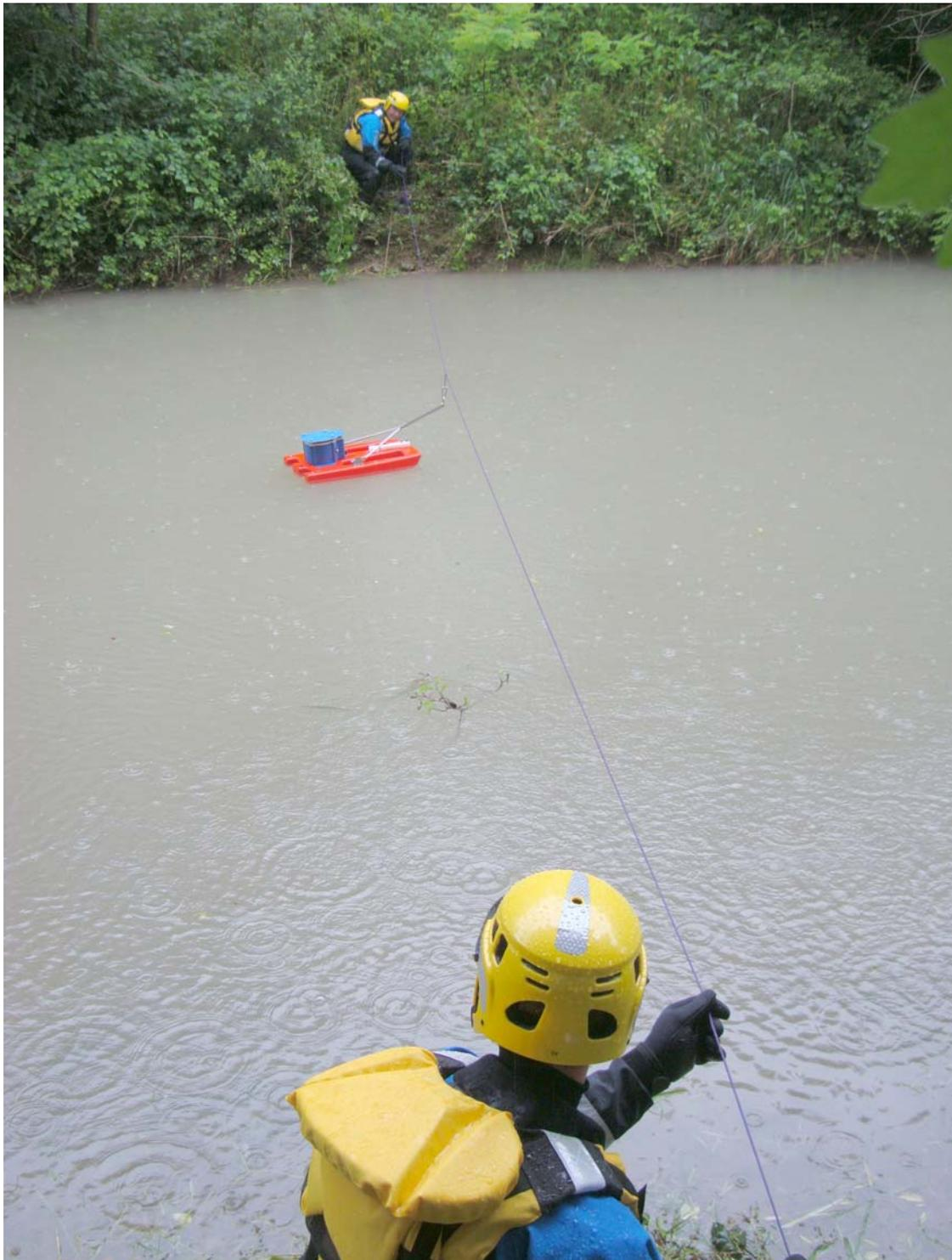
Fig . 8 – misura di portata con l'utilizzo di ADCP montato su natante
