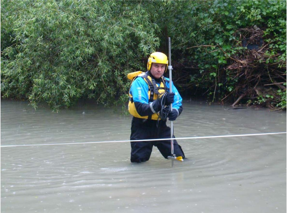
Fig. 6 - Operatore U.O.I. durante una misura di portata al guado con correntometri a elica
